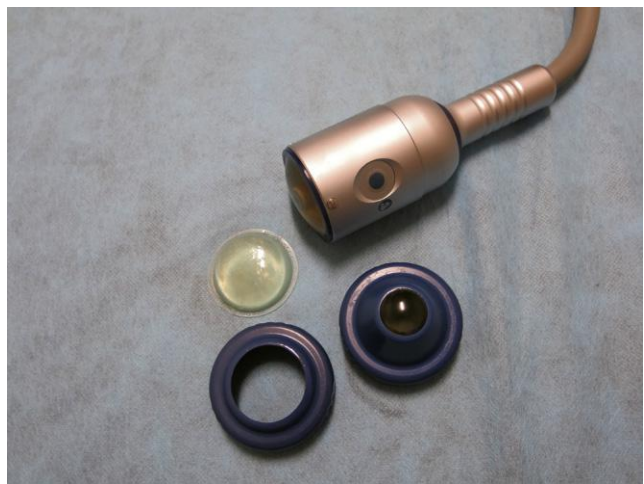
FIGURA 26.2 Detalle del aplicador de un equipo de ondas de choque de tipo focal electromagnético.
